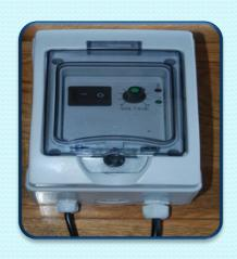
Ce Boîtier de contrôle va permettre de réguler les concentrations nécessaires de cuivre et d'argent Il est muni d'un interrupteur / fusible, d'un afficheur digital indiquant le voltage ou l'ampérage, le décompte numérique pour l'inversion de polarité, d'un potentiomètre de demande.
